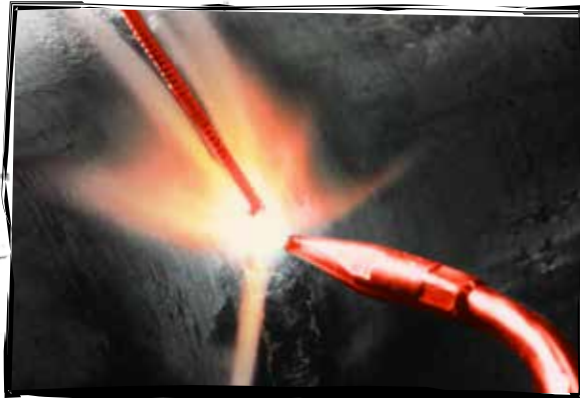
Flammlöten mit Brenngas oder Brenngas-Luft-Flamme
